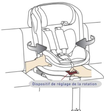
① Tirez d'une main le dispositif de réglage de la rotation et faites pivoter le siège de sécurité de l'autre main. Il est possible de faire pivoter le siège vers la droite ou vers la gauche ;
