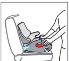
Poussez fermement les deux bras de verrouillage dans les guides jusqu'à entendre un « déclic » des deux côtés. Si l'ISOFIT est correctement verrouillé, un repère vert apparaît normalement sur le bouton de déverrouillage. Veuillez vérifier.
