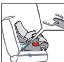
Introduzca firmemente los dos brazos de bloqueo en las guías de inserción hasta oír un sonido mecánico (clic) en ambos lados. Si el ISOFIT está correctamente bloqueado, aparecerá una marca verde en el botón de desbloqueo de la cinta. Compruébelo.
