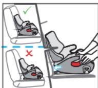
Agarre el cuerpo del asiento para comprobar si está bien fijado o si se mueve. Si el asiento se mueve y los brazos de bloqueo se salen, repita los pasos anteriores y vuelva a instalarlo.
