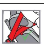
Tirez sur la ceinture et attachez la ceinture normalement. La ceinture sous-abdominale doit passer sous les accoudoirs du siège enfant et la partie diagonale doit passer au-dessus de l'accoudoir du siège enfant.
