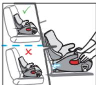
Saisissez la structure du siège afin de vérifier que ce dernier est bien attaché et qu'il ne bouge pas. Si le siège bouge et que les bras de verrouillage sont sortis, répétez la procédure ci-dessus et réinstallez-le.
