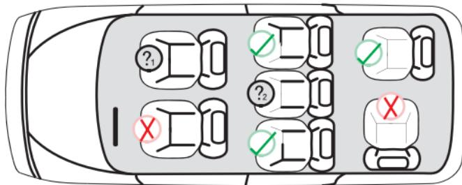
**?<sub>1</sub>** Ne pas utiliser sur ce siège si un airbag frontal passager est activé.
