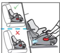
Afferrare la struttura del seggiolino per controllare che sia ben fissata e non oscilla. Se la struttura oscilla e i connettori ISOFIX sono estratti, ripetere la procedura sopra descritta e ripetere l'installazione .
