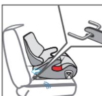
Schieben Sie die zwei Rastarme fest in die Einführhilfen, bis ein Klickgeräusch auf beiden Seiten zu hören ist. Wenn die ISOFIT Fixierung in geeigneter Weise und korrekt fixiert ist, erscheint eine grüne Markierung auf der Lösetaste. Überprüfen Sie dies bitte.
