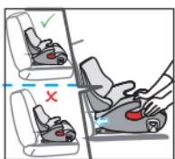
Agarre no corpo da cadeira para verificar se está bem apertada ou se abana. Se a cadeira abanar e os braços de bloqueio estiverem retirados, repita os passos acima e instale-a novamente.
