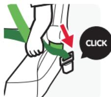
Setzen Sie den Kindersitz in das Fahrzeug und setzen Sie Ihr Kind in den Kindersitz. Führen Sie den oberen Teil des Fahrzeug-Sicherheitsgurts durch den Haken in der Kopfstütze und den unteren Teil des Fahrzeug-Sicherheitsgurts durch die Armlehne. Dann verriegeln Sie das Schloss des Sicherheitsgurtes. Straffen Sie nun den Fahrzeugsicherheitsgurt.
