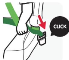
Coloque el asiento infantil en el vehículo y coloque al niño en el asiento infantil. Pase la parte superior del cinturón de seguridad del vehículo por el gancho del reposacabezas, la parte inferior del cinturón de seguridad del vehículo por el reposabrazos y, a continuación, abroche la hebilla del cinturón de seguridad. A continuación, tense el cinturón de seguridad del vehículo.
