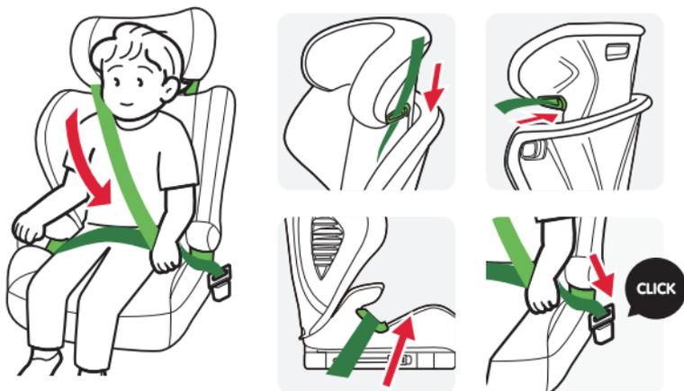
Posizionare il seggiolino nel veicolo e mettere il bambino seduto sul seggiolino. Far passare la parte superiore della cintura di sicurezza del veicolo attraverso il gancio nel poggiatesta, la parte inferiore della cintura di sicurezza del veicolo attraverso il bracciolo, quindi bloccare la fibbia della cintura di sicurezza. Quindi stringere la cintura di sicurezza del veicolo.
